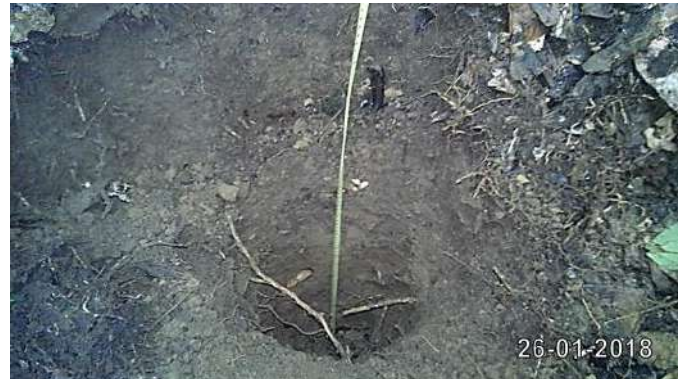
Foto 10. Toma de muestra de suelos y caracterización en sitio de las condiciones y perfiles estratigráficos para formar la muestra MS-Y-01.
