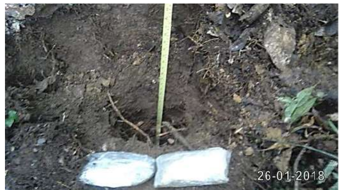
Foto 12. Toma y rotulación de muestra de suelo MS-Y-01.
