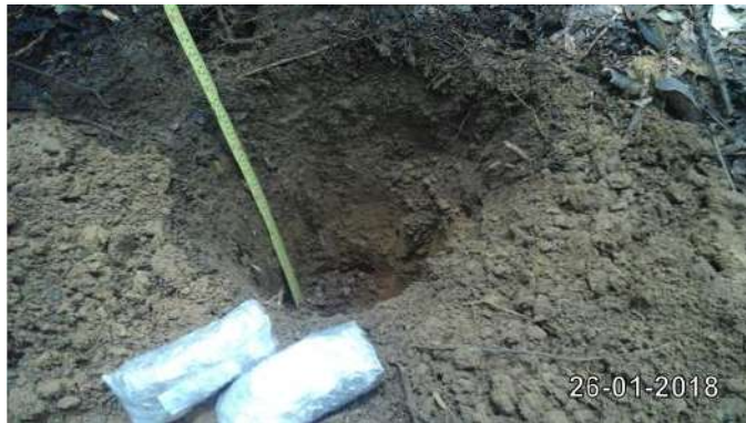
Foto 15. Toma y rotulación de muestra de suelo MS-Y-02.
