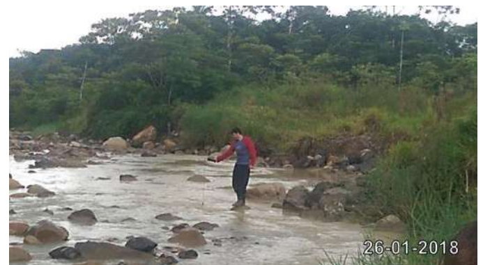
Foto 6. Toma de parámetros in situ en el sitio de muestreo, aguas abajo de la concesión minera. (MA-Y-02)
