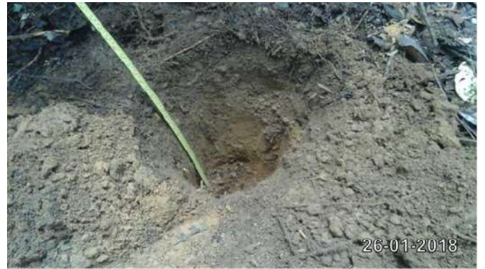
Foto 14. Toma de muestra de suelos y caracterización in situ de las condiciones y perfiles estratigráficos para formar la muestra MS-Y-02.
