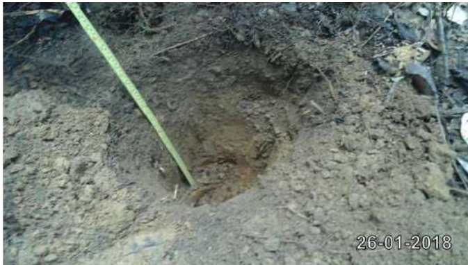
Foto 13. Toma de muestra de suelos y caracterización in situ de las condiciones y perfiles estratigráficos para formar la muestra MS-Y-02.
