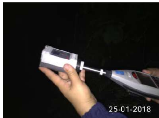
Foto 30. Calibración del sonómetro.
