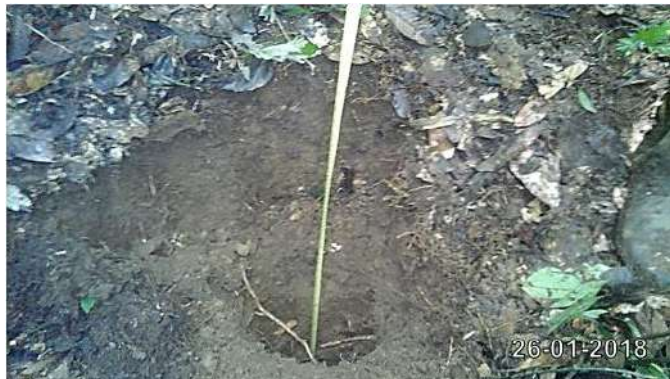
Foto 9. Toma de muestra de suelos y caracterización en sitio de las condiciones y perfiles estratigráficos para formar la muestra MS-Y-01.
