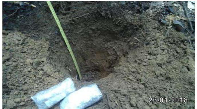
Foto 16. Toma y rotulación de muestra de suelo MS-Y-02.
