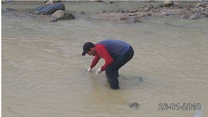
Foto 7. Toma de muestra de agua en el cuerpo hídrico, aguas abajo de la concesión minera. (MA-Y-02)
