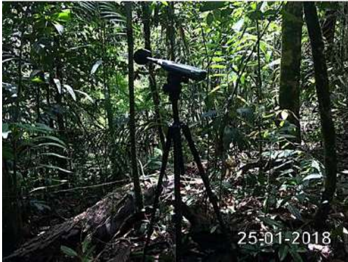
Foto 25. Monitoreo de nivel de presión sonora ambiental diurno en el punto MR-Y-02.
