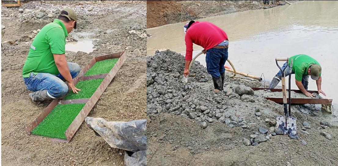
Ilustración 5. Armado del canalón y procesamiento de la muestra.
