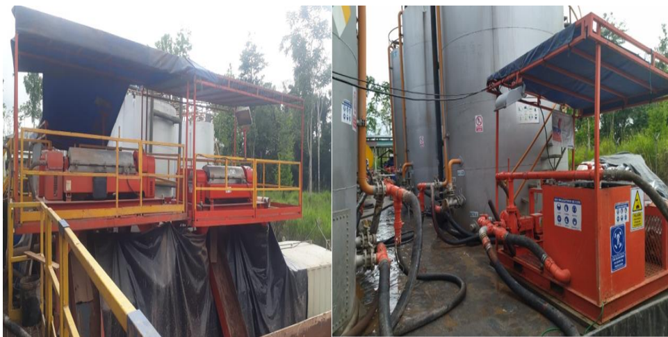
Figura 26 Sistema de Deshidratación de lodos TIPO
