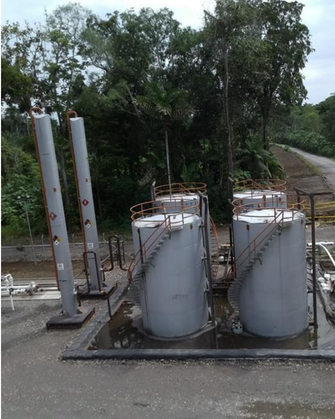
Figura 32 Sistema de Separación TIPO
