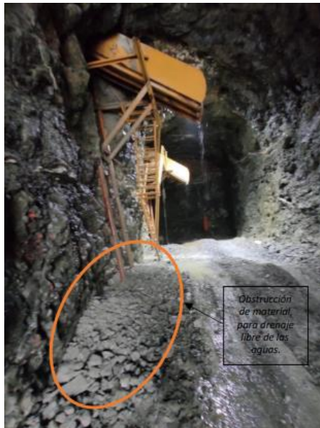
Figura 179. Vista lateral buzones de llenado. Fuente: Departamento técnico “Quebrada Fría”
