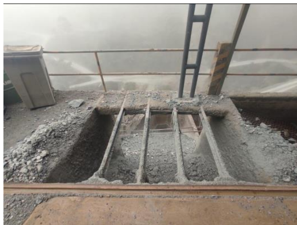
Figura 175. Corona de tolva para caja Fuente: Departamento técnico "Quebrada Fría"
