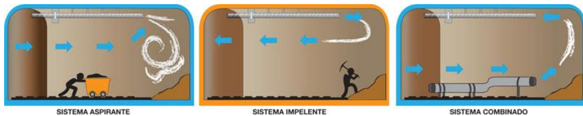
Figura 157. Sistema de ventilación mixto Fuente: Administrador de la concesión Quebrada Fría. Elaboración: Equipo consultor, 2023.
