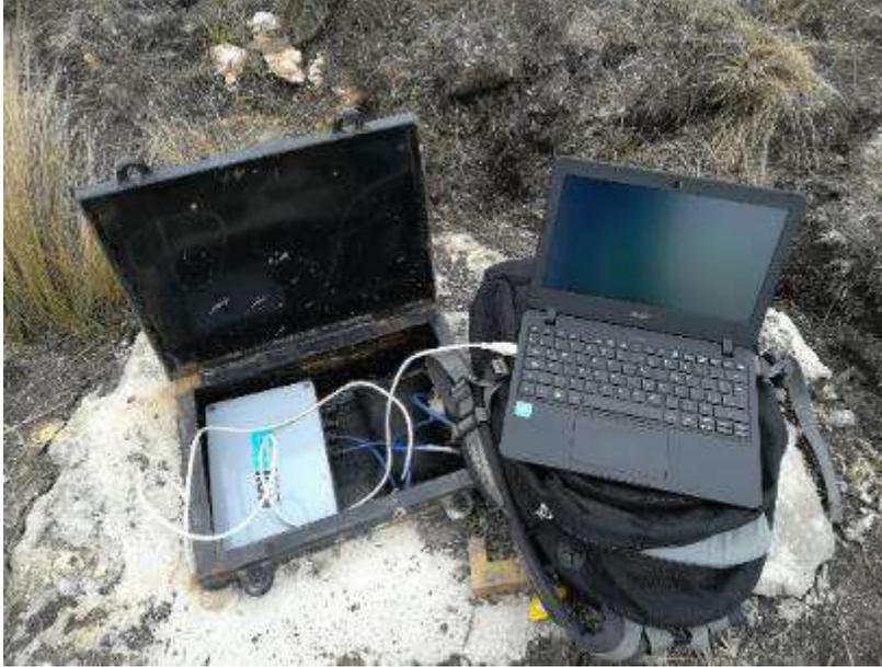
**Figura 6-205 Descarga de datos mediante software de Geokon**
