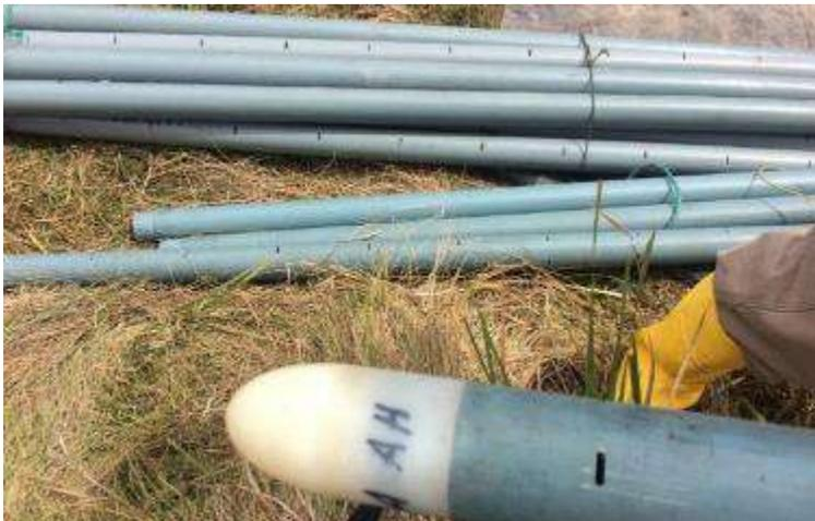
Tubería perforada (screen) por donde ingresa agua al piezómetro
