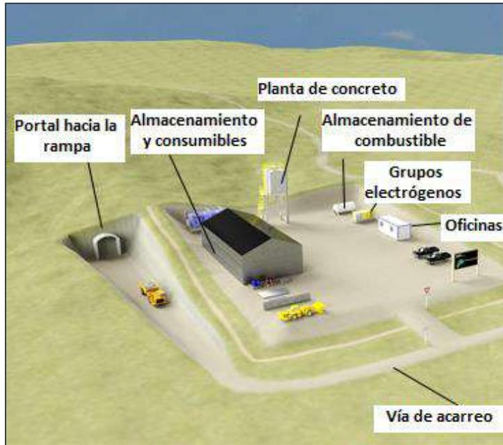
**Figura 7-11 Diagrama 3D del Área del Portal de la Mina**
