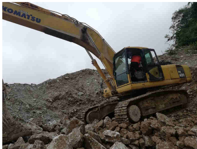
Fig. N.-2 Procesos de extracción, igualación de taludes y cotas en los cuerpos de la mina.
