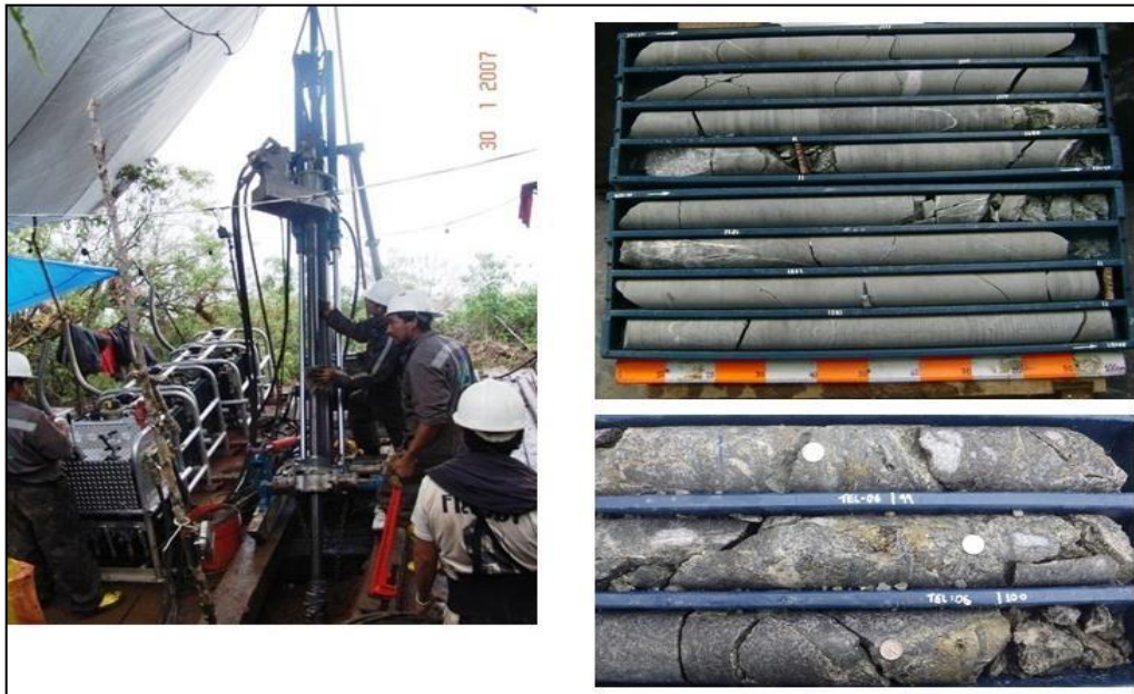
Figura 120. Perforación diamantina con recuperación de testigos de roca
