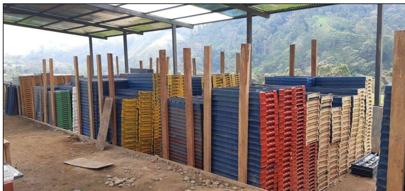
Figura 8-27 Almacenamiento del Testigo en Cajas.
