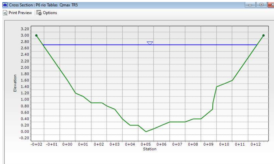
Figura 7-68 Nivel máximo TR5 en el río Tablas
