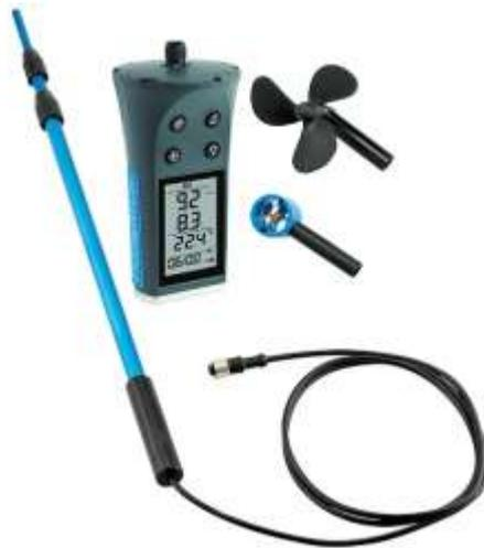
Figura 7-58 Equipo de aforo – Correntómetro JDC
