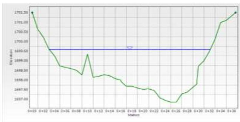
Figura 7-79 Resultados de Flow master nivel de crecida TR 5 años en la sección transversal del río Loyola aguas arriba en AG-01
