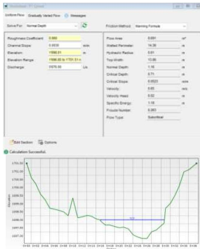
Figura 7-78 Resultados del nivel medio en la sección transversal del río Loyola aguas arriba en AG1
