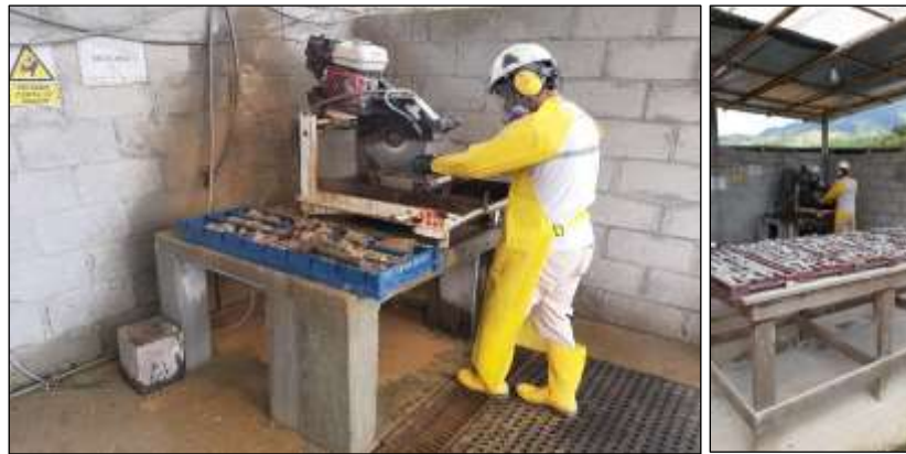
Figura 8-24 Corte de Testigos.
