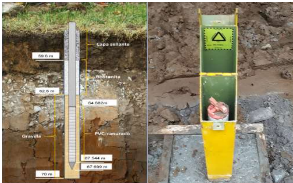
Figura 8-11 Estructura de un Piezómetro.
