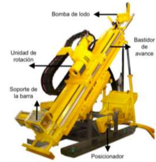
Figura 8-13 Taladro de perforación y sus componentes
