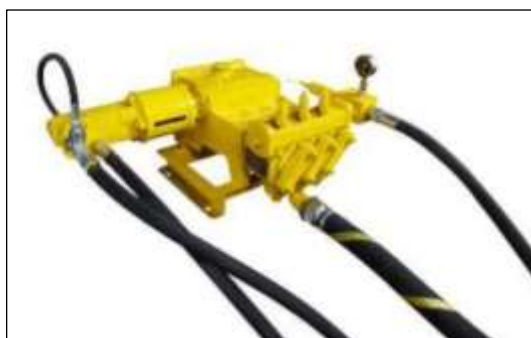
Figura 8-20 Esquema de bomba de lodos.
