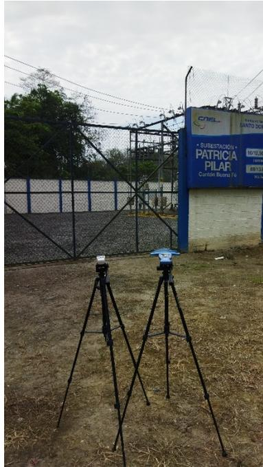
**Fotografía 1:** Monitoreo de radiaciones no ionizantes – RNI-1 – Subestación 5 (Patricia Pilar)
