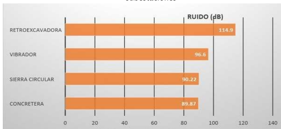
Gráfica 240. Decibeles herramientas más ruidosas en la construcción de la línea de transmisión y subestaciones
