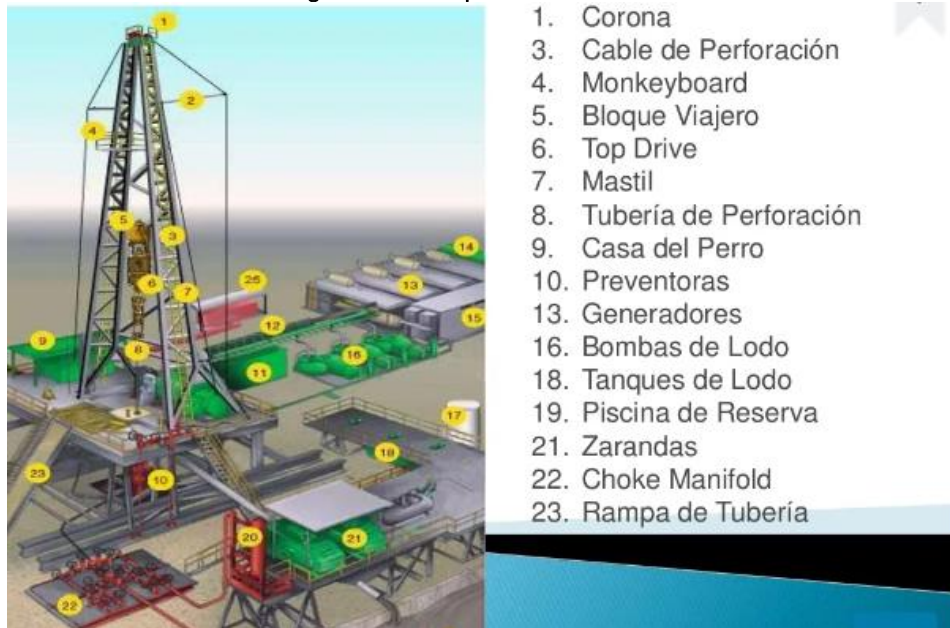
Figura 19. Componentes del Taladro de Perforación
