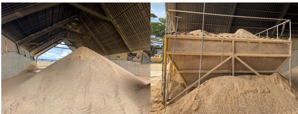
Ilustración 7.8. Sistema de abastecimiento del material triturado a las tolvas
