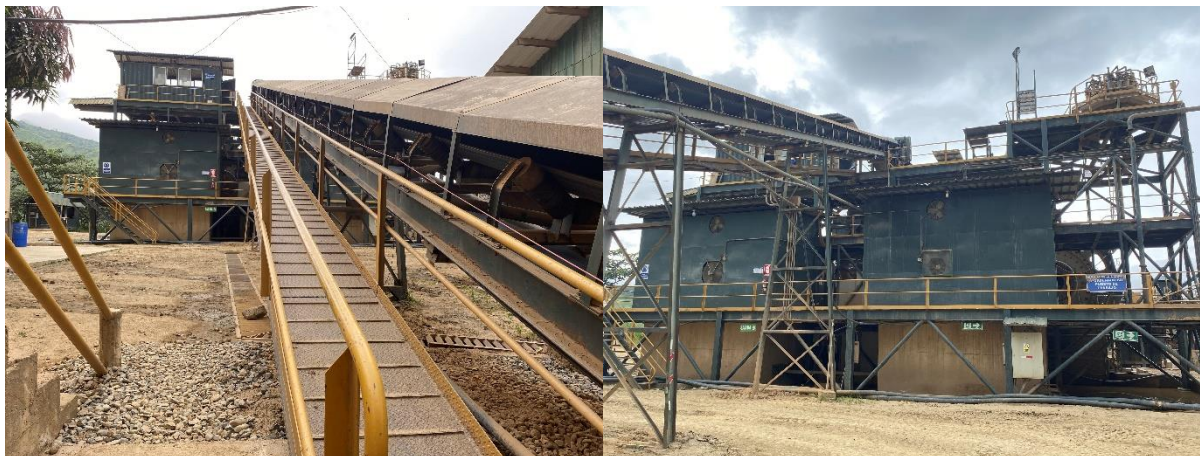
Ilustración 7.10. Conducción del material por bandas transportadoras hacia el molino de bolas
