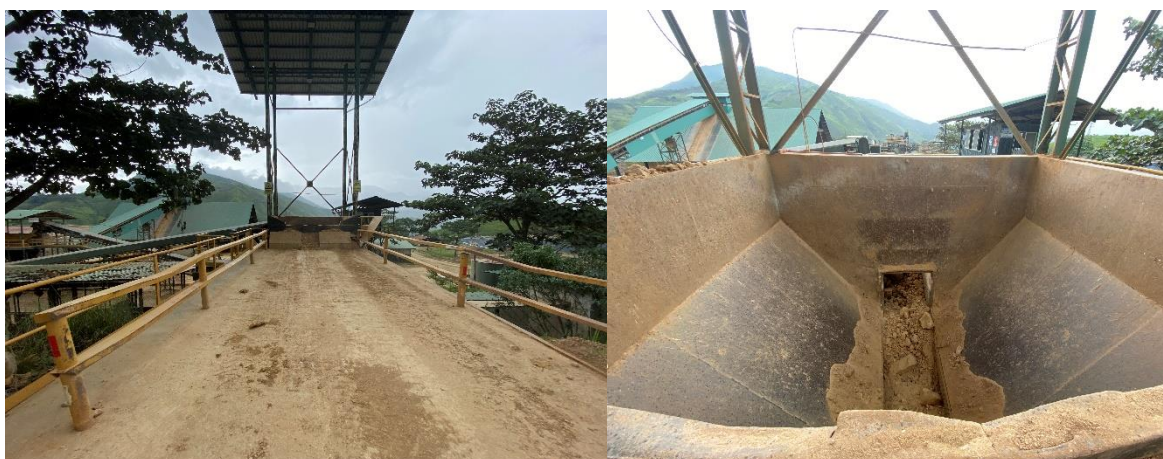
Ilustración 7.2. Ingreso del material a la tolva de recepción para la trituración primaria
