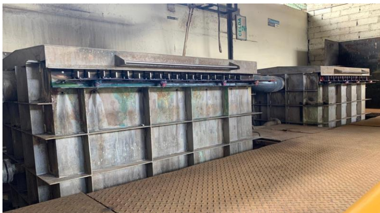
Ilustración 7.16. Celdas electrolíticas para recuperación de los metales
