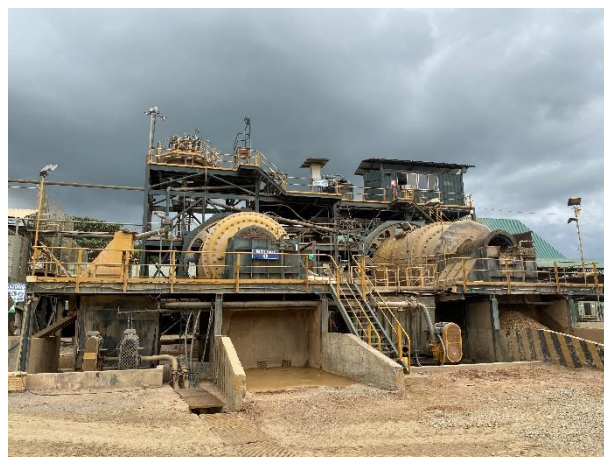
Ilustración 7.11. Molino de bolas dispuesto en paralelo
