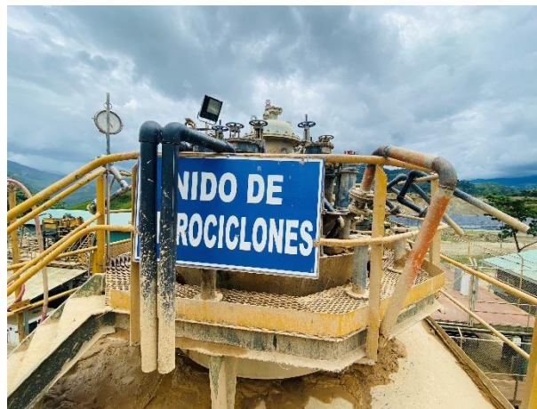
Ilustración 7.12. Hidrociclón para la clasificación del material de tamaño final \leq 200\mu
