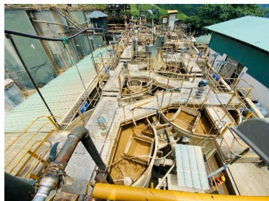
Ilustración 7.13. Tanques para el circuito de carbón activado
