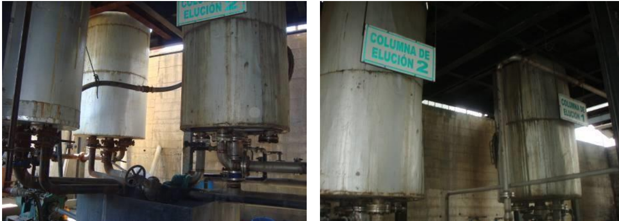
Ilustración 7.15. Columnas de elución donde se extrae el oro del carbón activado
