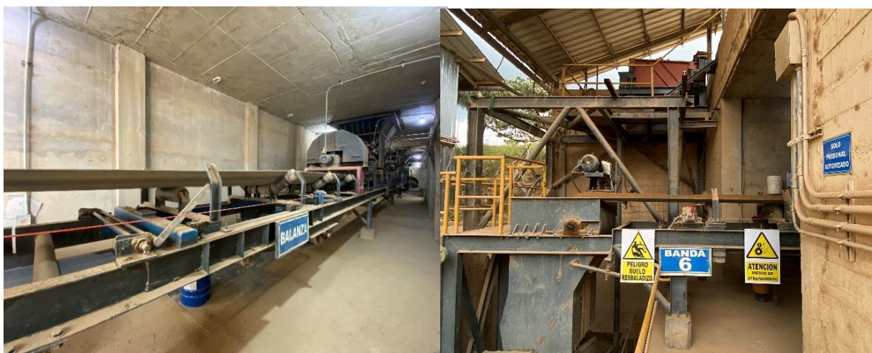
Ilustración 7.9. Sistema de pesado y conducción del material triturado por las bandas transportadoras
