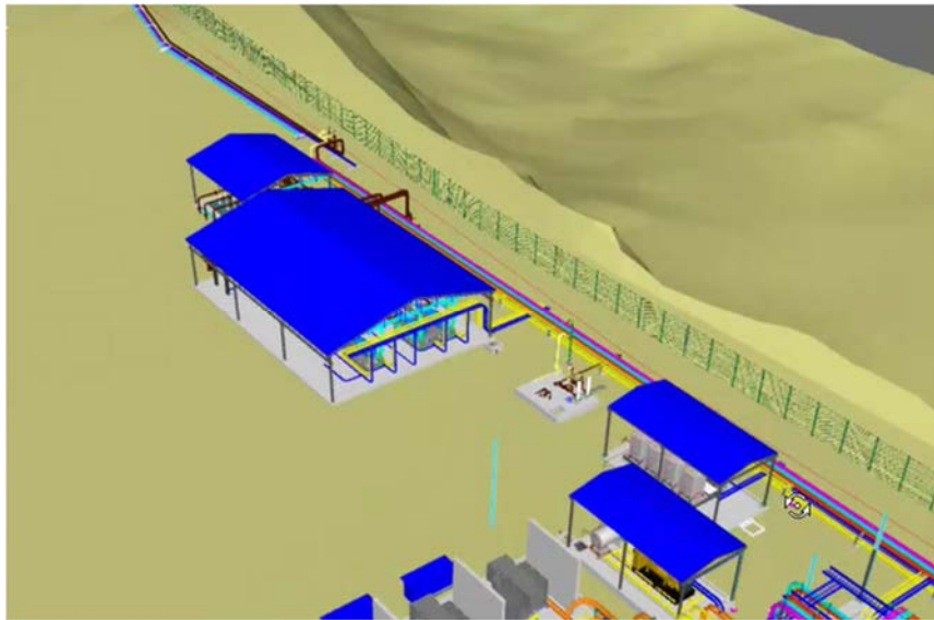
Figura 3-67 Techado de equipos en plataforma Oglán 3– sistema de drenajes abiertos
