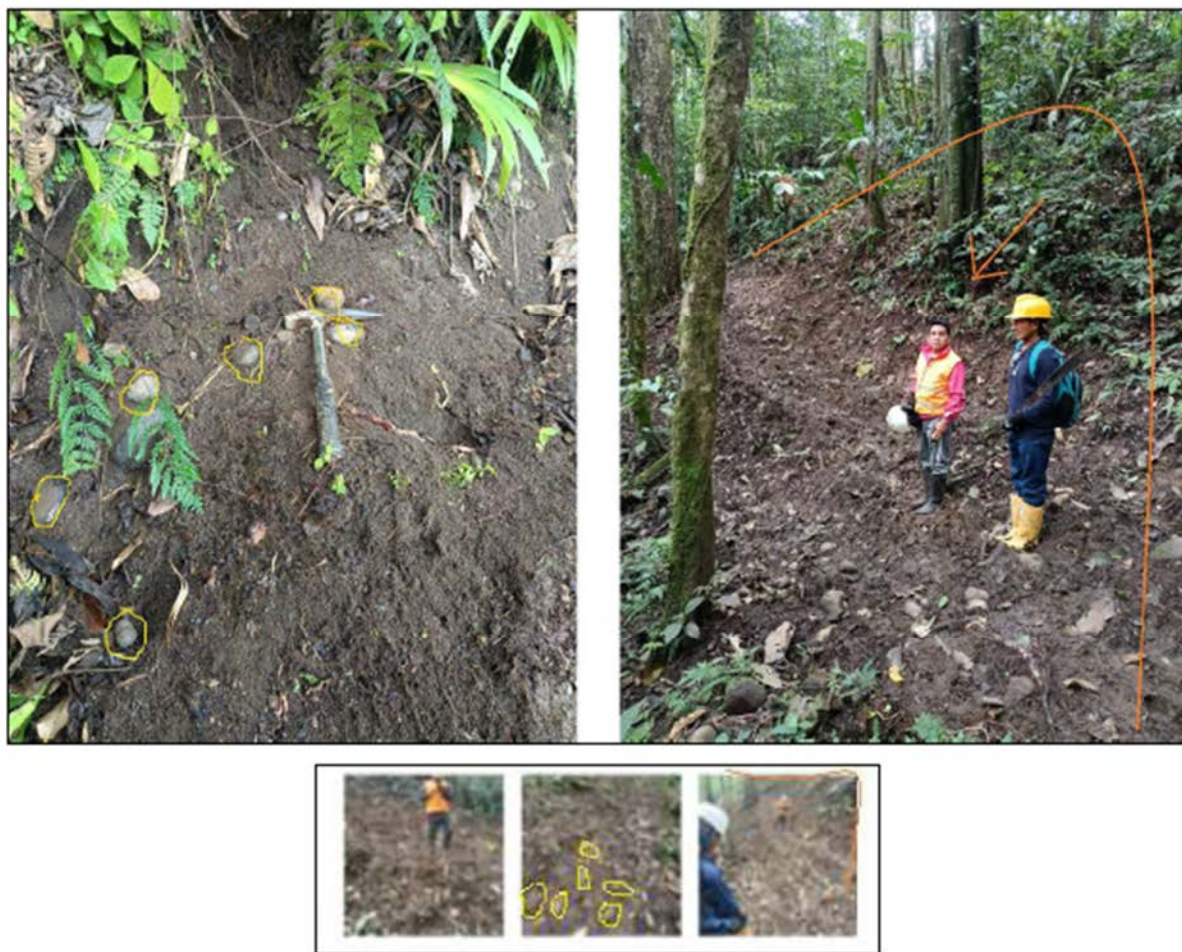
Figura 5-23 Transición de Zonas saturadas arcillosas (izquierda), conglomerados (centro). Ubicación E: 202142 N: 9851479 (UTM WGS84 18S)
