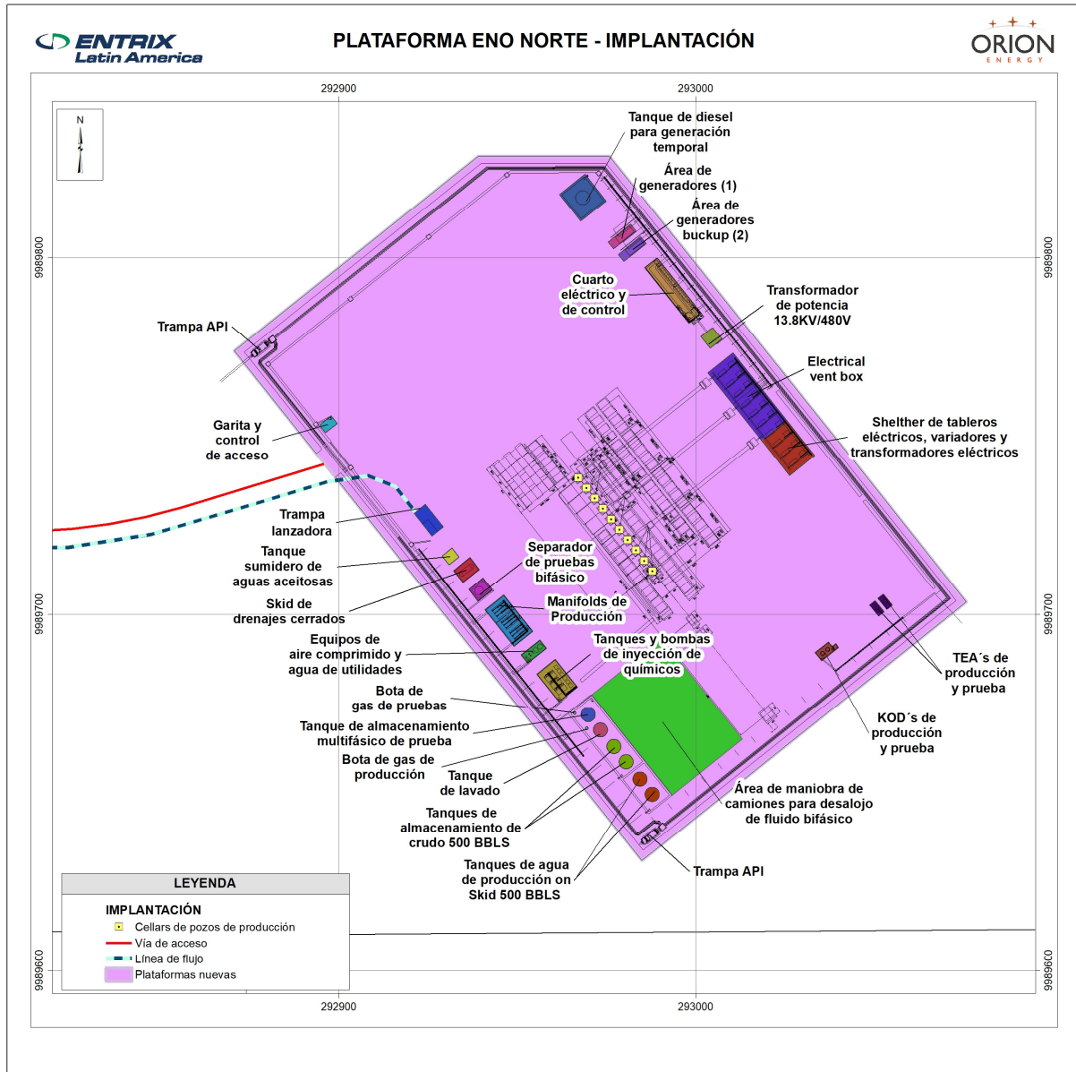
Figura 5-3 Implantación tentativa de plataforma Eno Norte
