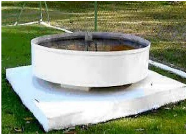
Figura 4-21 Medición del índice de evaporación en un depósito de área conocida.
