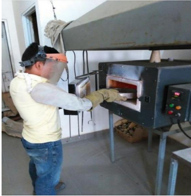
Figura 4-20 Secado de relaves y concentrados para la obtención del % de humedad
