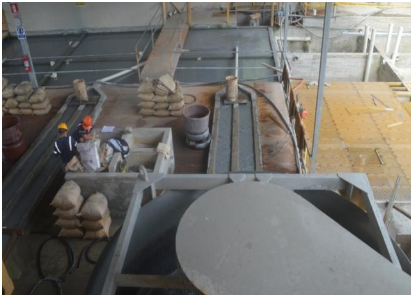
Figura 15 Piscinas de sedimentación de relaves del circuito: Trituración, molienda y concentración
