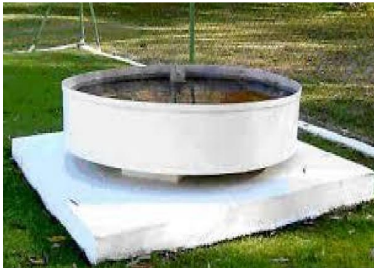
Figura 33 Medición del índice de evaporación en un depósito de área conocida.
