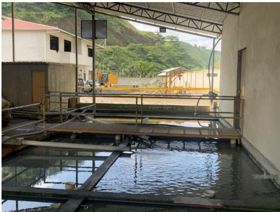
Figura 41 Piscina de sedimentación, arenas de molienda. Elaborado por: ENERMILL CIA. LTDA./TAIAO CONSULTORES, 2026
