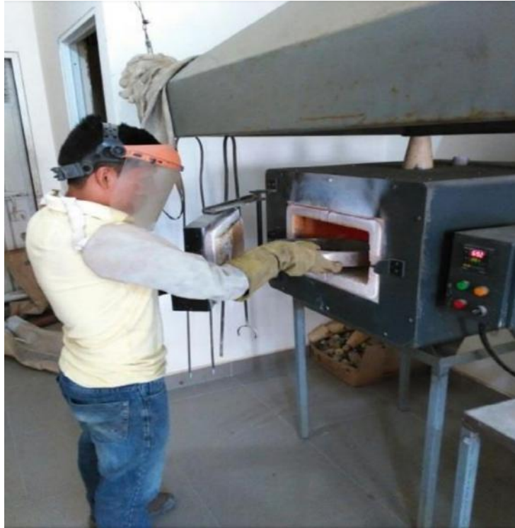
Figura 5-24 Secado de relaves y concentrados para la obtención del % de humedad
