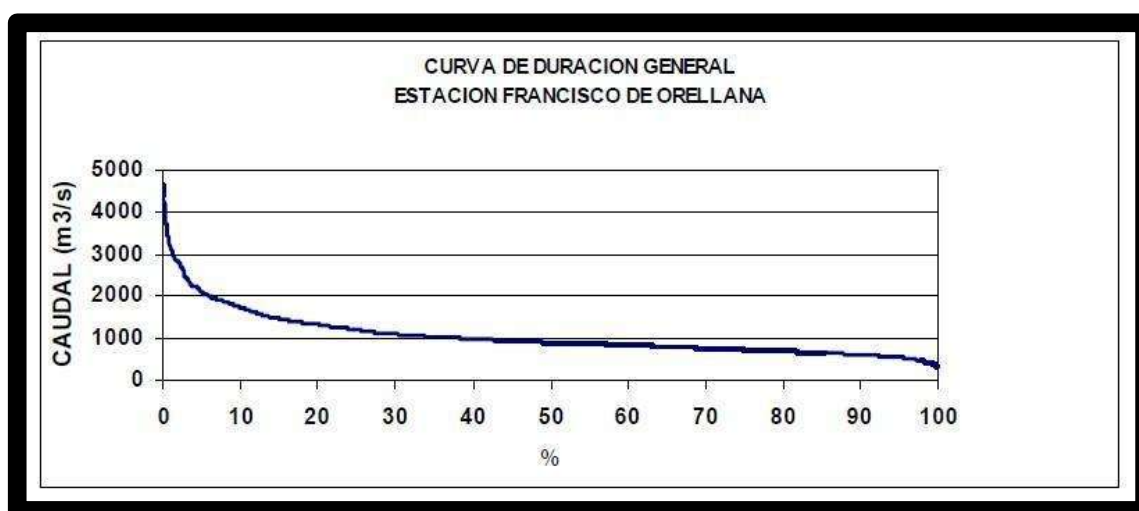
FIGURA 5- 39: CURVA DE DURACIÓN DE CAUDALES
