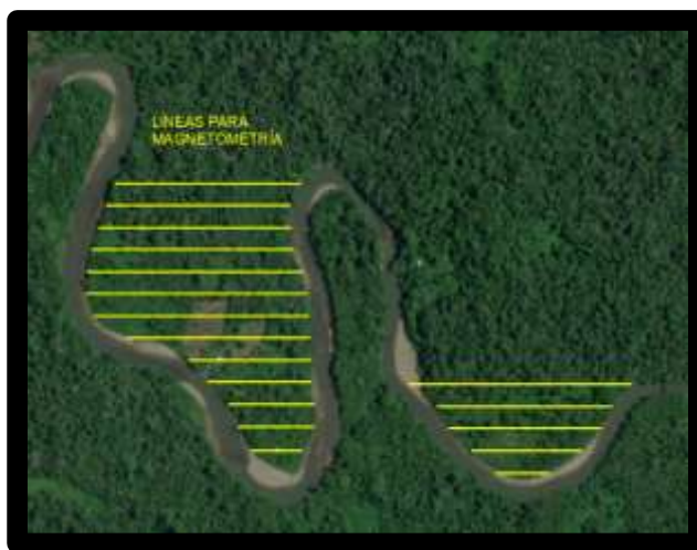
FIGURA 6-11: EJEMPLO DE LÍNEAS DE MAGNETOMETRÍA Y TOPOGRAFÍA
