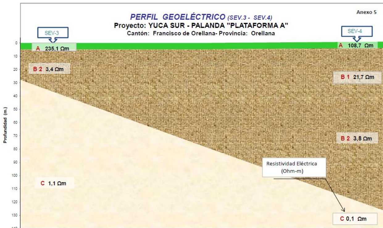
Figura 49. Perfil Geoeléctrico SEV3 y SEV4
