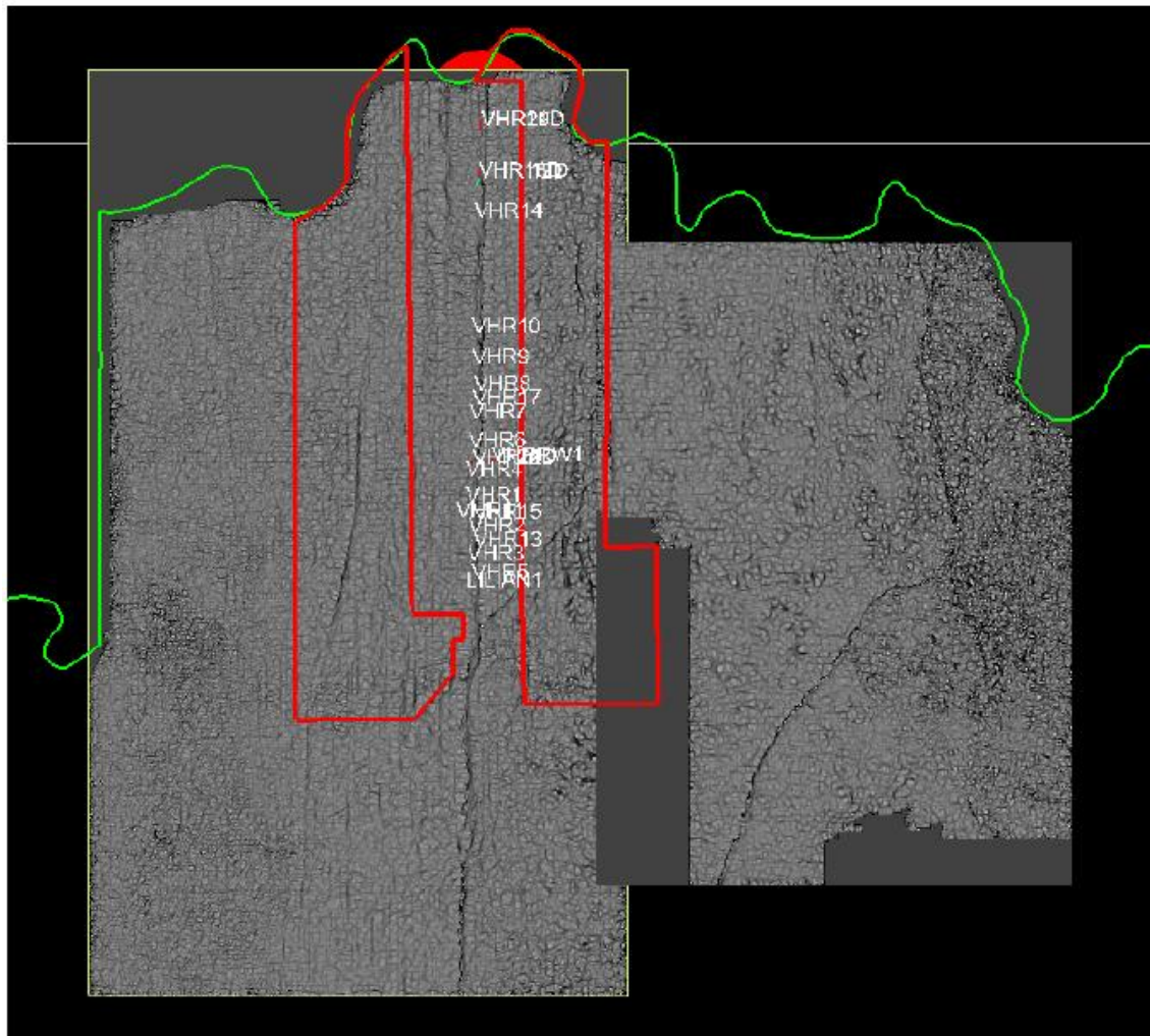
Figura 12. Cubo sísmico interpretado representado en time slice del atributo curvatura máxima para identificar lineamientos de fallas
