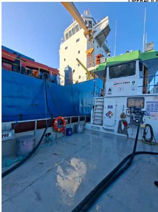
ILUSTRACIÓN 17: MANGUERAS PARA LA MANIOBRA DE COMBUSTIBLE
