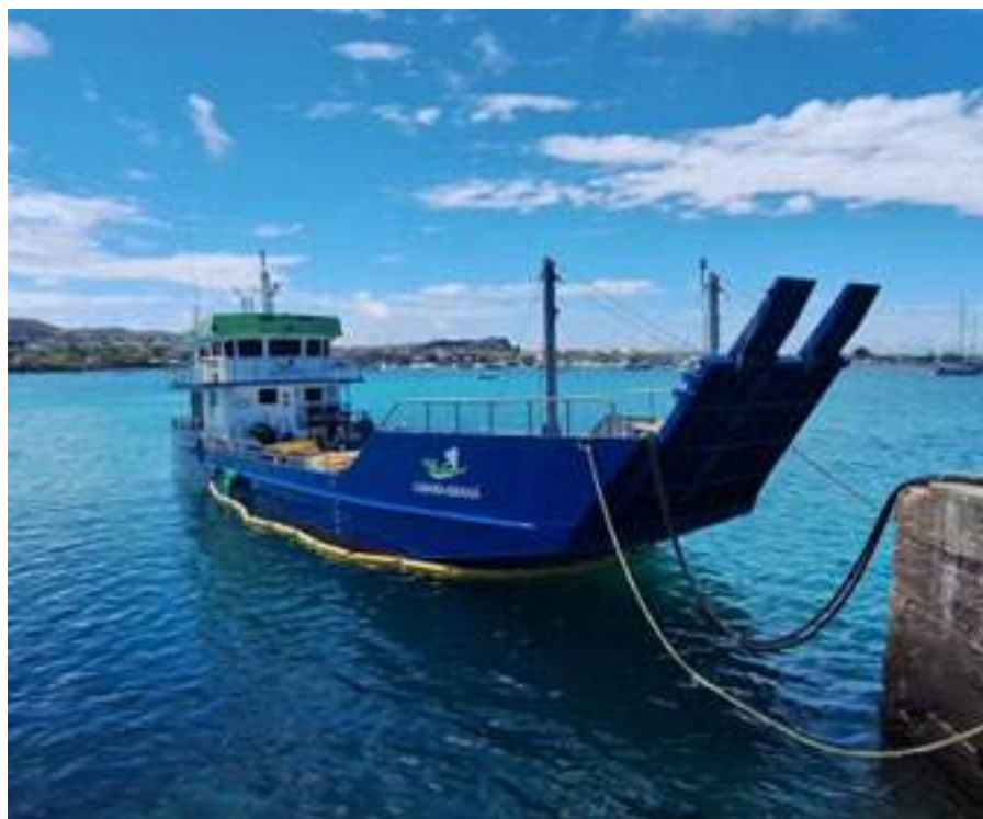
ILUSTRACIÓN 21: BARRERAS DE CONTENCIÓN
